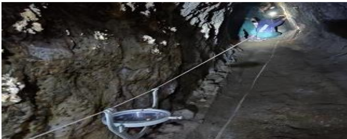
Trabajos de mensura subterránea con Brújula colgante en la Coop. Min. Perazani – Cochabamba
